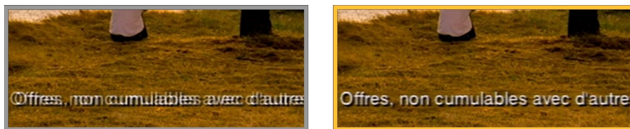
图 2. 传统拉伸算法（左侧）以及高级拉伸算法（右侧）在移动文字上产生不同的视觉质量结果
