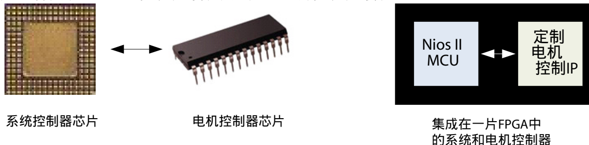
图 2. 传统的 MCU/DSP 设计（左侧）和基于 FPGA 的设计（右侧）
