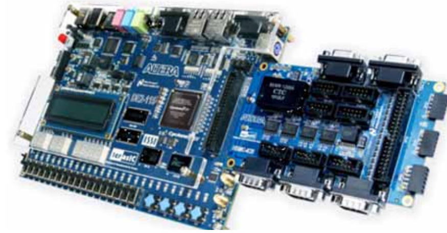
图 17. 含有 Altera Cyclone IV E FPGA 的工业网络套件
